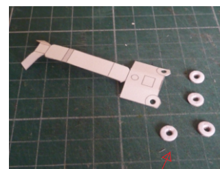
trou \varnothing 2,0mm B5 4X 1,0mm d'épaisseur
