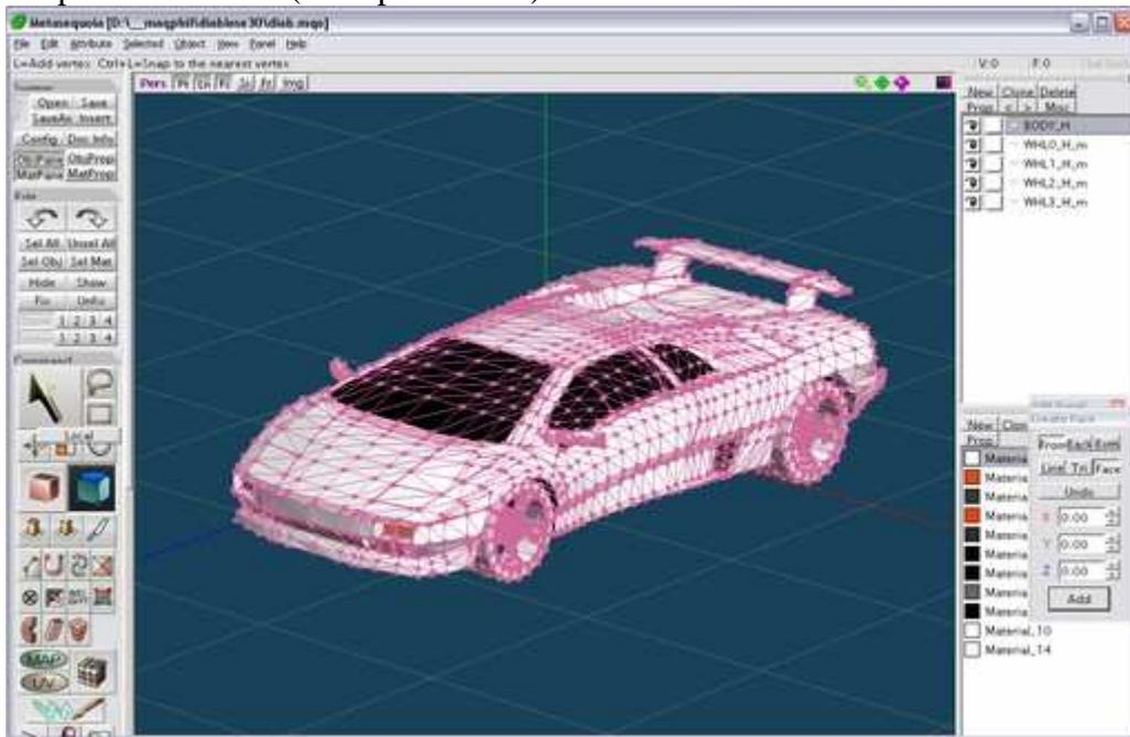
On decoupe la voiture par le milieu car pas besoin des 2 cotés ils sont identiques. Pour cela se mettre en vue de face et sélectionner tous les points avec l'outil Lasso rectangle jusqu'au milieu comme ceci et faite supp.
